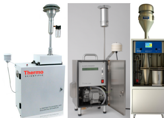
Figure 15 : Préleveur Partisol (à gauche), Leckel (au centre), DA80 (à droite).
